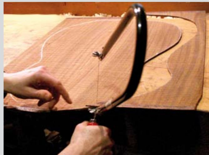
Alles von Hand: Aussägen des seit 1995 gelagerten Palisanderbodens.
