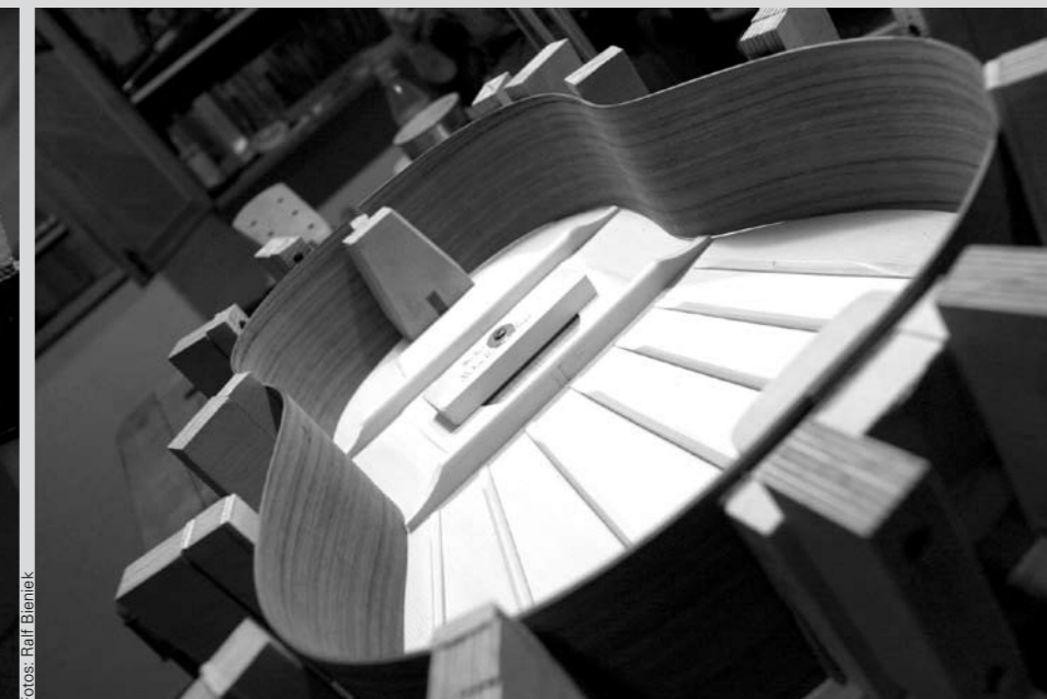
Links: Eine fertig gebogene Zargenhälfte.
