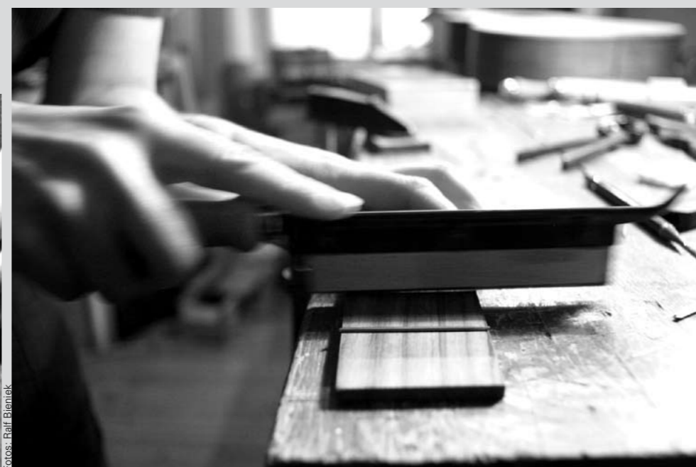
Links: Einsägen der Bundschlitze, die dann den Bunddraht aus Neusilber aufnehmen.
