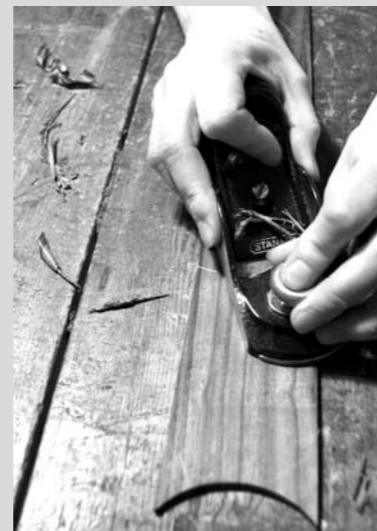
Griffbrett wird an den Hals angepasst und auf Stärke gehobelt.
