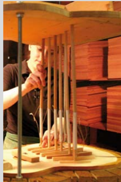
Aufleimen der Fächerbalken auf die mittlerweile über 20 Jahre alte Fichtendecke mit Druckstangen und Heißleim.
