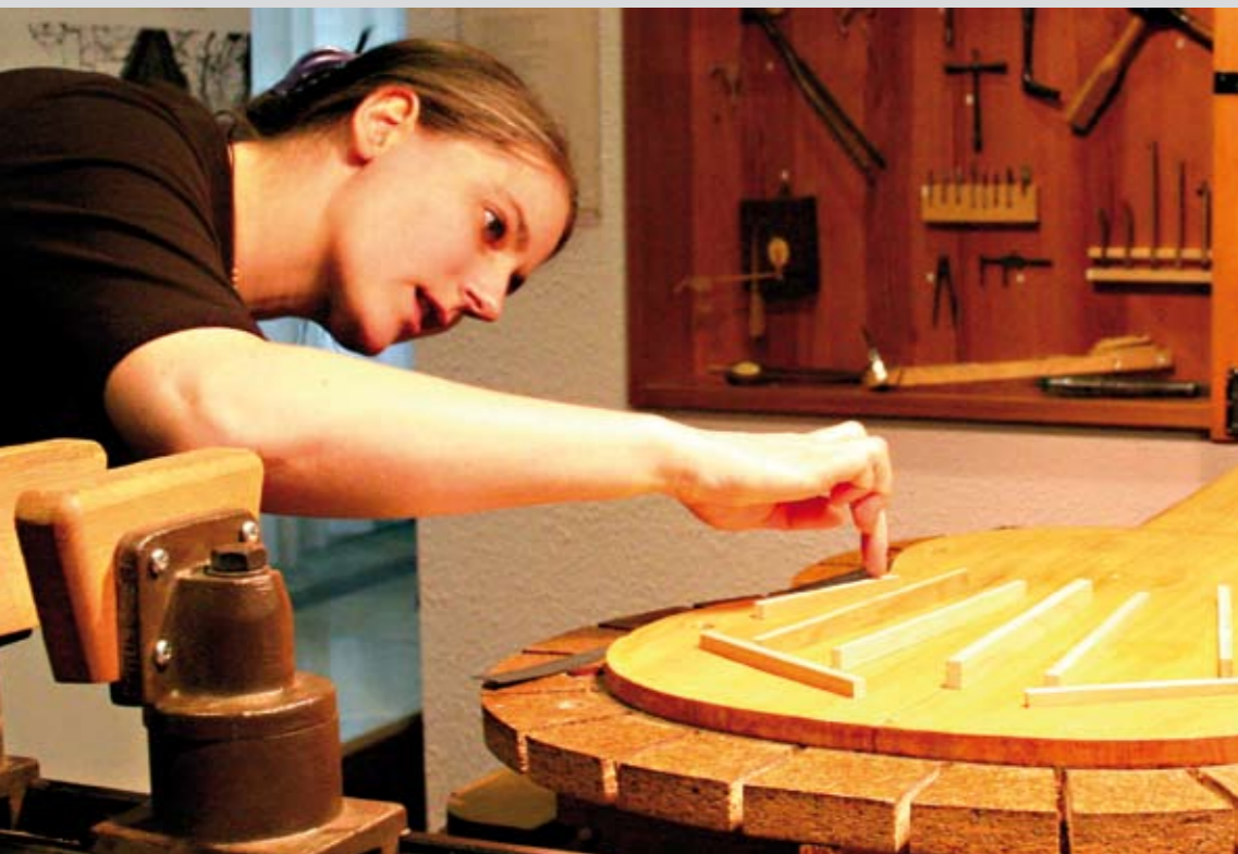
Links: Anpassen der Fächerbalken an die Konkavwölbung der Solera (Negativform).
