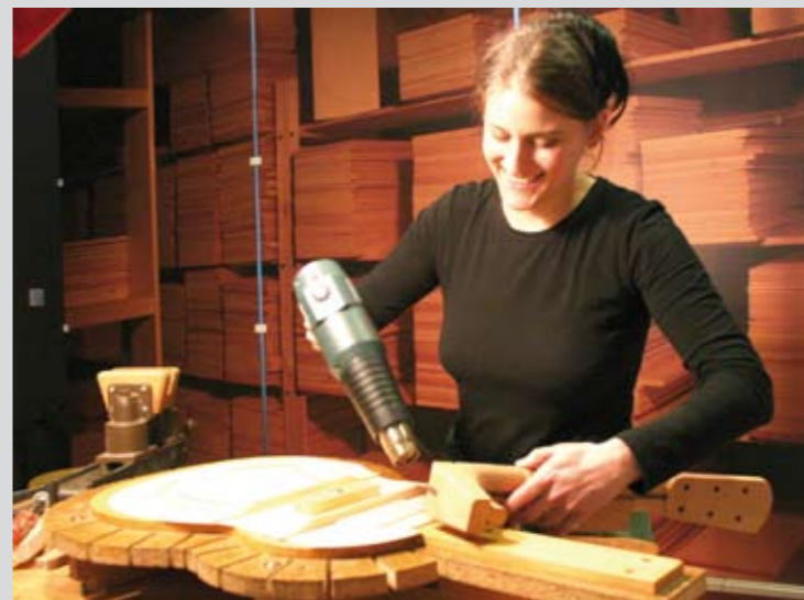
Aufleimen des Halses auf die Decke mittels spanischer Hals-Korpus-Verbindung. Der Heißleim braucht eine warme Umgebungstemperatur, damit die Leimverbindung gelingt.
