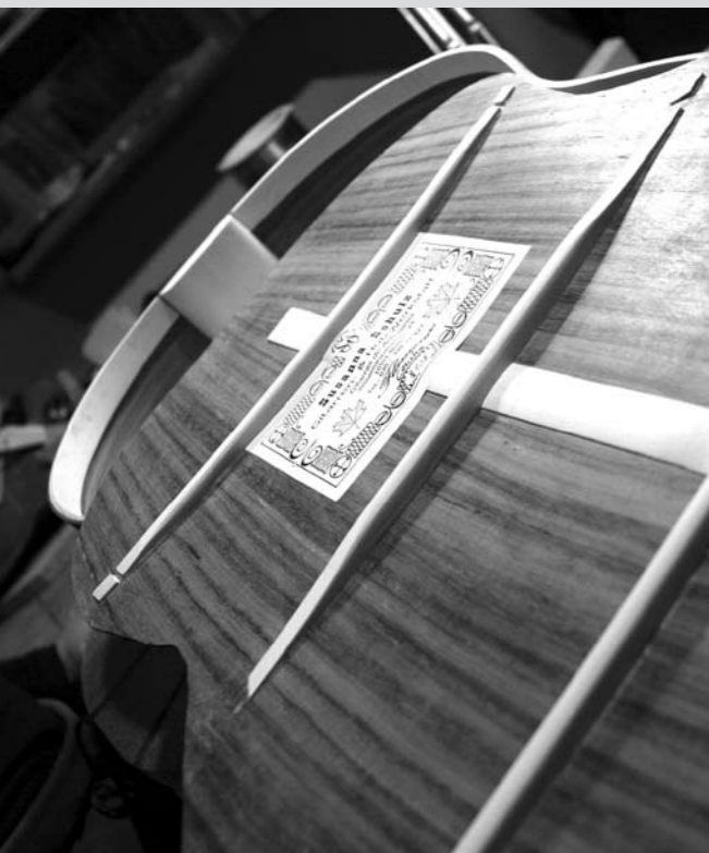
Links: Boden mit handsigniertem, konservativ gestaltetem Zettel. Er enthält Herstellernamen, Jahrgang, Modellbezeichnung und fortlaufende Werkstattnummer zur eindeutigen Identifikation. Fertig zum Aufleimen. In der Mitte: Fugbelag aus Deckenresten (Fichte).
