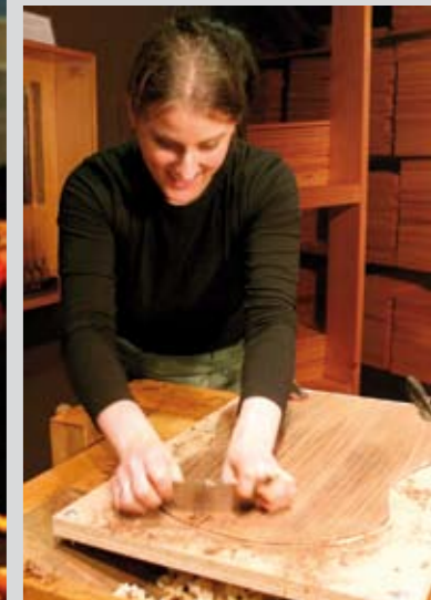
Feines Ausarbeiten des Palisanderbodens mit der Zieh Klinge, einem unersetzlichen Universalwerkzeug
