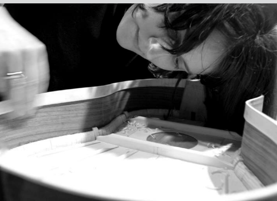
Links: Schleifen der Reifchen.
