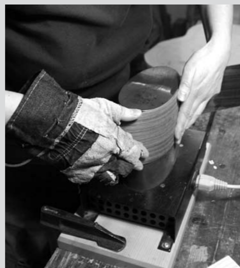
Die angefeuchtete Zarge wird gebogen mit einem Biegeisen.
