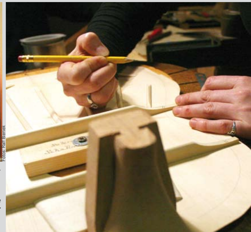
Aufleimen des Halses auf die Decke mittels spanischer Hals-Korpus-Verbindung. Der Heißleim braucht eine warme Umgebungstemperatur, damit die Leimverbindung gelingt.
